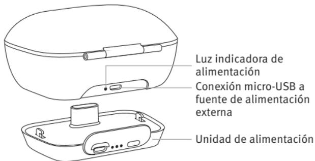
Conexión micro-USB a fuente de alimentación externa
