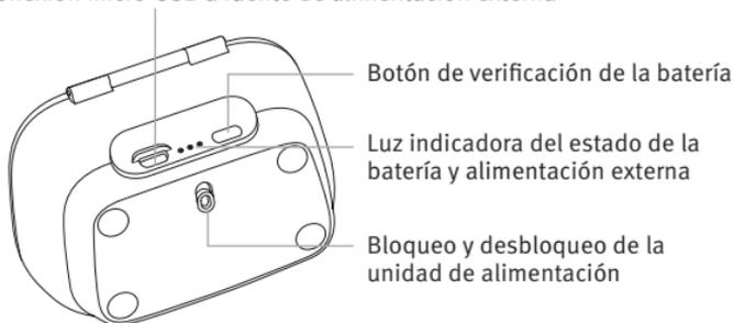
El cargador Combi BTE 2 se puede utilizar con una fuente de alimentación externa que cumpla las especificaciones indicadas en la tabla siguiente:
